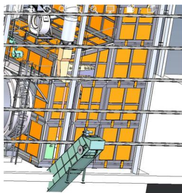
Figura 7 - Redler de recolha de cinzas e escórias do forno. (Fonte: MD do EIA, 2025)
